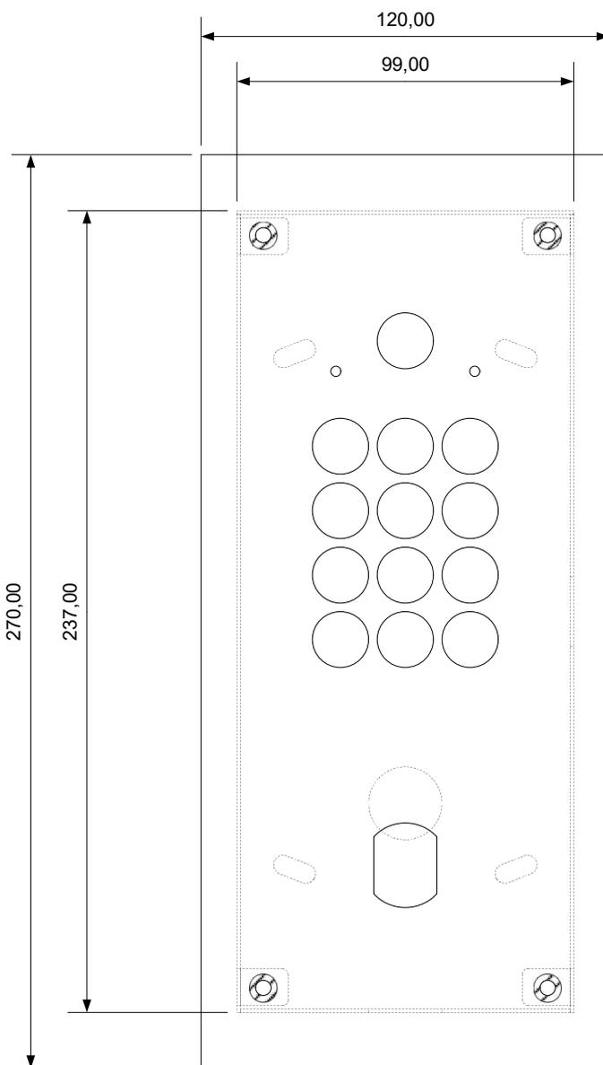
Hauteur de pose comprise entre 0,9 et 1,30 m du sol fini
